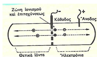
Καθοδικός σωλήνας με κάθοδο - και άνοδο + και αριστερά τα θετικά ιόντα
