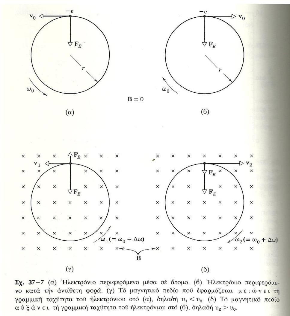
**Σχ. 37-7** (α) Ήλεκτρονίο περιφερόμενο μέσα σέ άτομο. (β) Ήλεκτρονίο περιφερόμενο κατά τήν αντίθετη φορά. (γ) Τό μαγνητικό πεδίο που έφαρμόζεται μειώνει τή γραμμική ταχύτητα του ήλεκτρονίου στό (α), δηλαδή  $v_1 < v_0$ . (δ) Τό μαγνητικό πεδίο αυξάνει τή γραμμική ταχύτητα του ήλεκτρονίου στό (β), δηλαδή  $v_2 > v_0$ .
