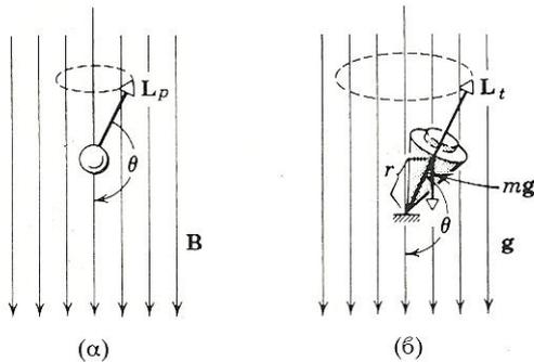
**Σχ. 37-17** (α) Περιστρεφόμενο γύρω απ' τον εαυτό του πρωτόνιο που εκτελεί μετάπτωση μέσα σε εξωτερικό μαγνητικό πεδίο και (β) στροβιλιζόμενη σπούρα που εκτελεί μετάπτωση μέσα σε εξωτερικό πεδίο βαρύτητας.  $L_p$  και  $L_t$  είναι τα διανύσματα των στροφορμών.
